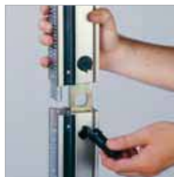
Удлинение направляющего рельса станины
