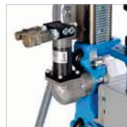
Безостановочное управление сверлением с помощью гидравлической подачи каретки
