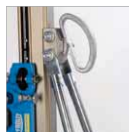
Максимальная прочность станины с увеличенной двойной диагональной опорой
